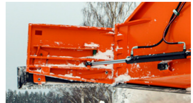
Trejon Optimal klaffskopa har hydrauliska sidoklaffar som kan vikas 75 grader framåt och 90 grader bakåt. Klaffarna har också flytande slitstål som följer marken.
