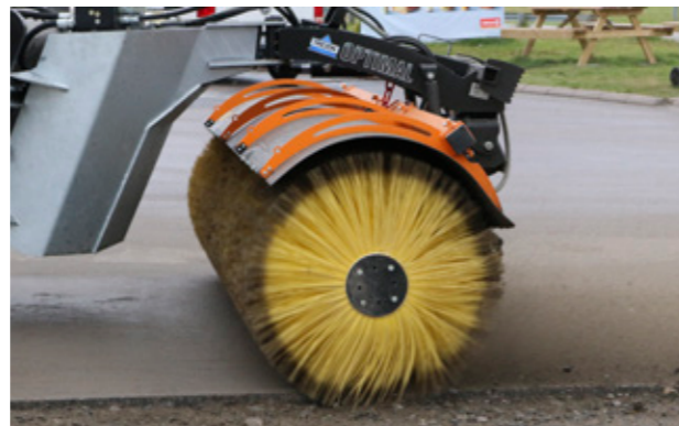
Vertikale und horizontale Pendelfunktion lassen die Kehrwalze immer dem Untergrund folgen. Ein integrierter Spritzschutz folgt der Kehrwalze.
