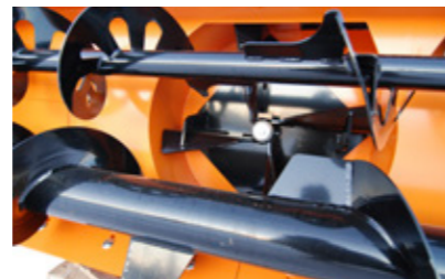
Turbinengehäuse aus Hardox-450 Hochleistungsstahl gefertigt.
