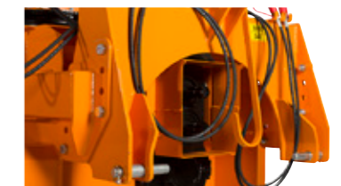
3-Punkt-Anbau, Front- oder Heckmontage.
