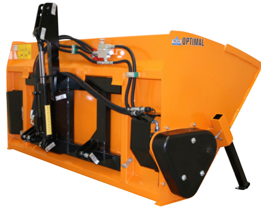
Trejon Optimal Walzenstreuer sind an alle Arten von Schnellwechslern angepasst. Die Abbildung zeigt den SP1000 mit 3-Punkt-Rahmen und optionaler Selbstladefunktion. Alle Modelle haben Verschleisschienen in HARDOX, werden sandgestrahlt und pulverbeschichtet
