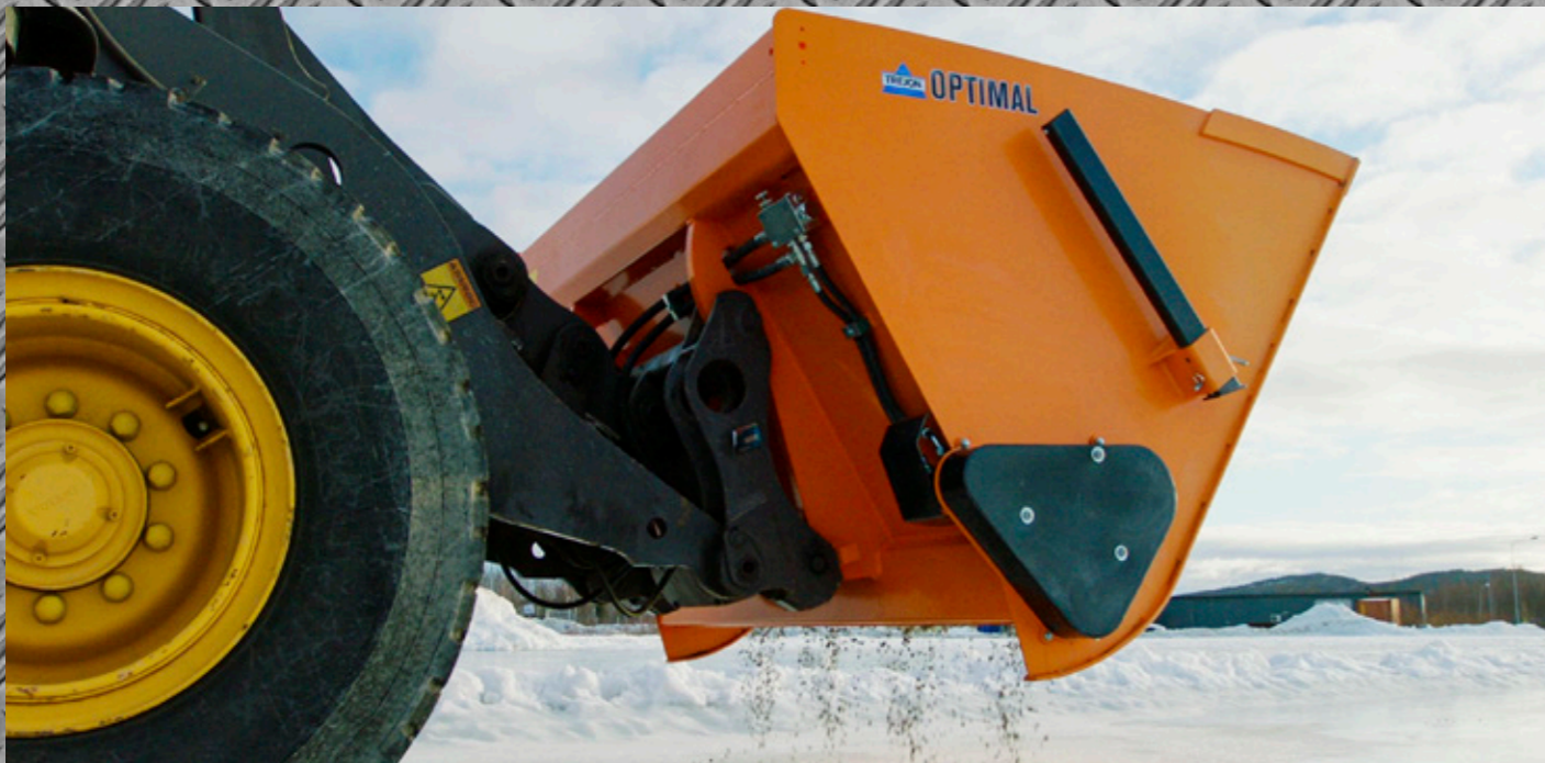
Trejon Optimal Walzenstreuer sind an alle Arten von Schnellwechslern angepasst. Das Bild zeigt den SP2700 an einem Radlader.
