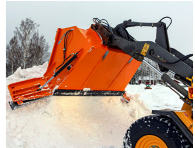
Die Räumschaufel hat eine immense Aufnahmekapazität, und dank der konischen Form mit abgerundeter Rückseite fällt der Schnee beim Entleeren/Kippen leichter heraus.
