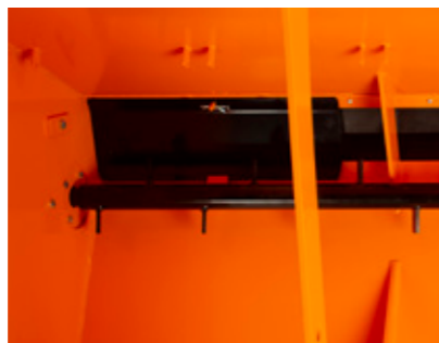
Serienmäßige robuste Umrührwelle und Einlegebleche zur mechanischen Streubildverstellung.
