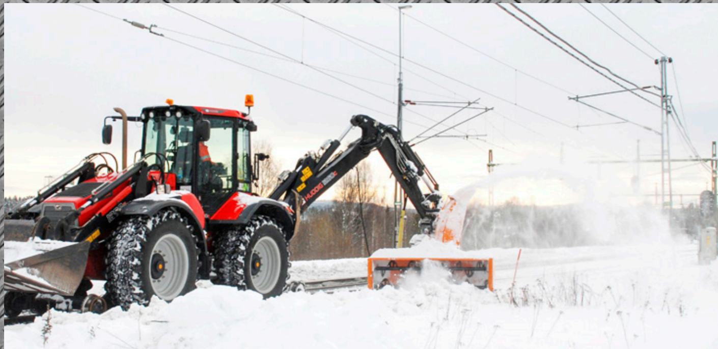
Hydraulische Schneefräse 2202H von Trejon Optimal, hier montiert an einem Huddig 1260, für die Schneeräumung an Bahnhöfen, Haltestellen und entlang der Gleise.
