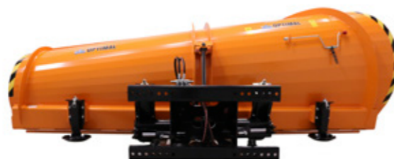
Pflug und Leiste pendeln gleichzeitig nach oben/unten.
