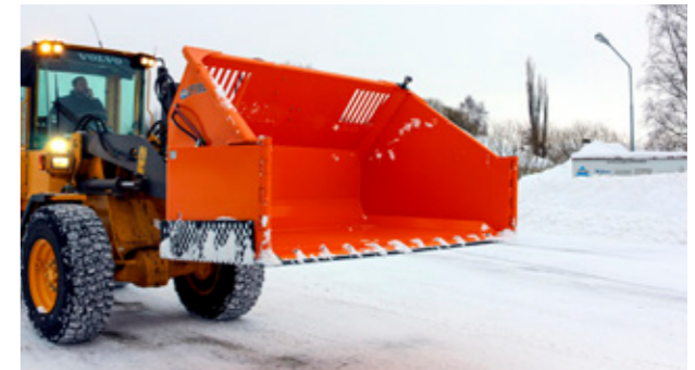
Die Räumschaufel hat eine immense Aufnahmekapazität, und dank der konischen Form mit abgerundeter Rückseite fällt der Schnee beim Entleeren/Kippen leichter heraus.
