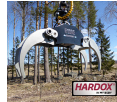
Reisiggreifer G120E Mit diesem Hardox Greifer kann Reisig ohne Mitnahme von Steinen oder Erde gegriffen werden, ideal für den Einsatz am Hacker. Erhältlich für Zapfen- und Flanschmontage, 120cm Öffnungsweite, 125kg Gewicht.
