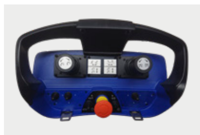
EHC-Funkfernsteuerung Scanreco Funkfernsteuerung mit 6 Proportionalfunktionen und 2 On/off-Funktionen.
