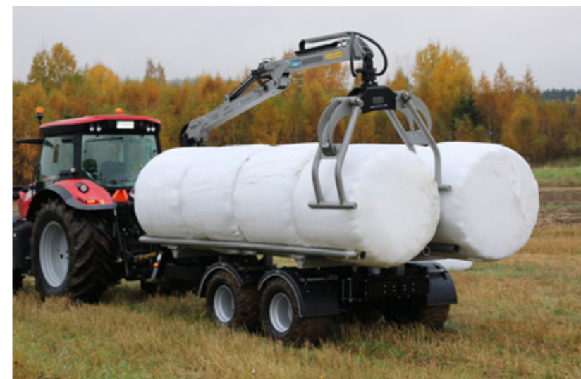
Ballenplattform Für den Transport von bis zu 11 Ballen auf Ihrem MF1202, der Greifer G130 kann hierzu mit einem Ballengreiferaufsatz erweitert werden.
