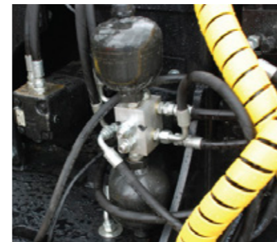
Kran- und Schwenkdämpfer Dieses System dämpft die Ladungsbewegungen ab und sorgt für eine verlängerte Lebensdauer aller Krankomponenten.
