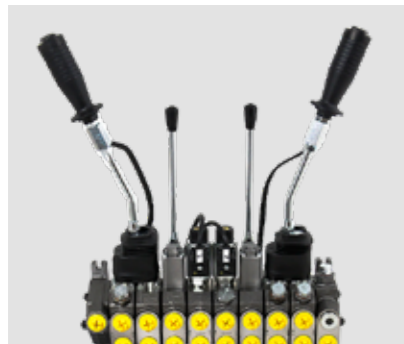
Elektro-mechanische Steuerung 2 XY-Funktionen plus zwei elektrische Funktionen mit Wippschaltern auf den Hebeln, sowie zwei separate mechanische Funktionen (Abstützungen).
