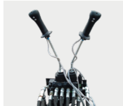
Leichtgewichtssteuerung 2 XY-Funktionen plus 4 Elektrische Funktionen über Druckknöpfe an der Vorder- und Rückseite der Hebel.
