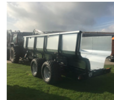
Reisigwanne Für den Transport von Reisig und Energieholz auf öffentlichen Strassen, ohne diese zu verschmutzen. Feuerverzinkt, sehr stabil und erhältlich für MF850 – 1202.
