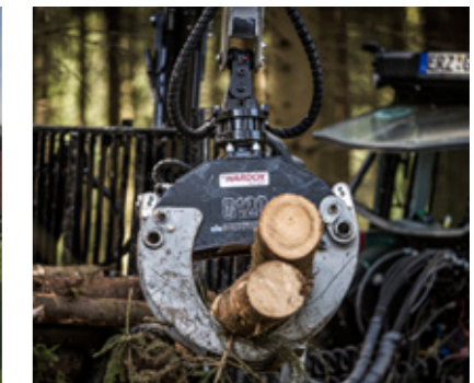
Rotatoren Trejon Multiforest bietet verschiedene Rotatorlösungen mit gebremsten und ungebremsten Gelenken an.
